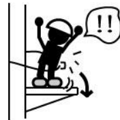
建設現場の墜落災害 安全帯不適正使用に よる事故
