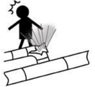
原子力発電所 2次配管ギロチン破断 配管減肉による
